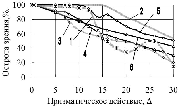
Рис. 9. Острота зрения в зависимости от призматического действия для некоторых призм
