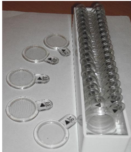
Рис. 1. Набор призмённых компенсаторов косоглазия КК-42
