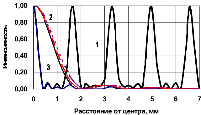
Рис. 3. Дифракционные эффекты для микропризмы PD = 30 \Delta : 1 — интерференционная картина для случая N = 4 ; 2 — дифракционная картина от одной щели для трех значений \beta (0, 6, 15°); 3 — интегральная дифракционная картина для угла \beta = 0^{\circ}
