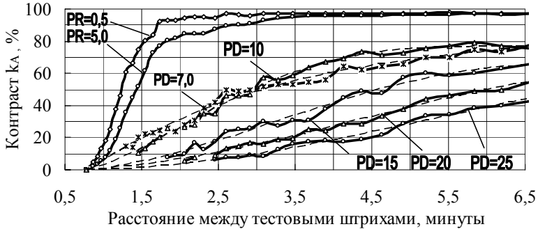
Рис. 6. Контрастность изображений тестовых штрихов миры МЗ–М5 для микропризм «3М» (США)
