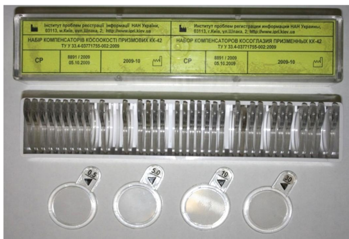
Рис. 2. Набір компенсаторів косооконості призмових КК-42
