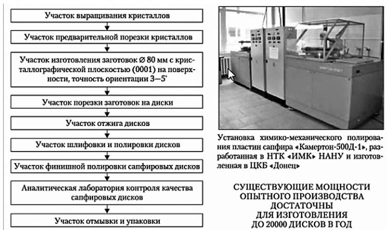
Рис. 6. Опытно-промышленный участок изготовления оптических сапфировых дисков
