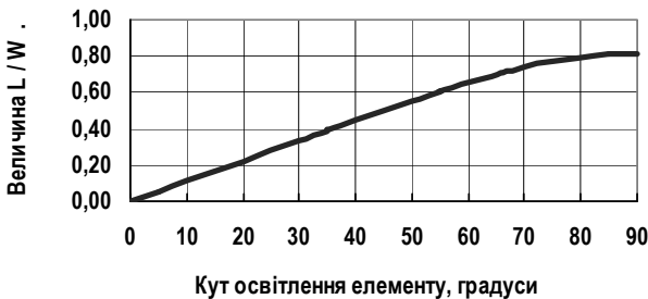
Рис. 2. Співвідношення між кроками L и W , при якому коефіцієнт активної апертури дорівнює 100 % для системи «полікарбонат–повітря»
