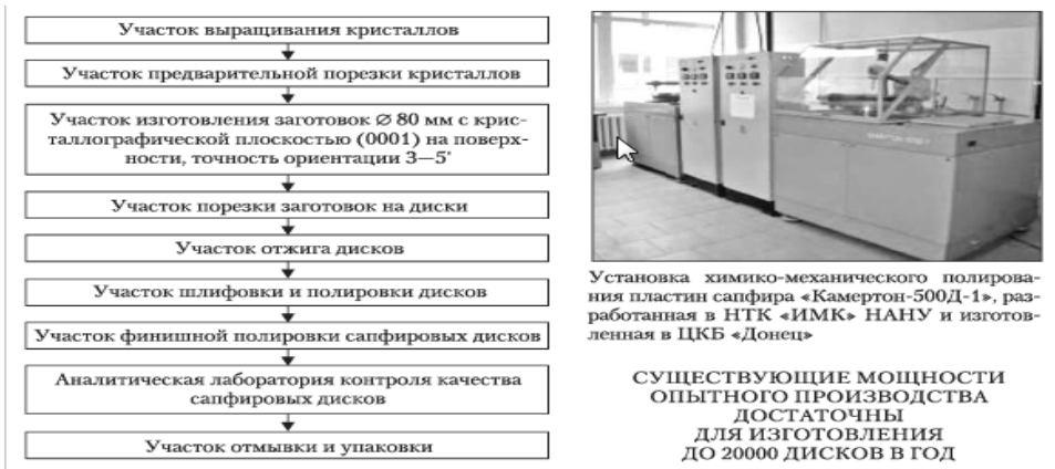
Рис. 7. Опытно-промышленный участок изготовления оптических сапфировых дисков
