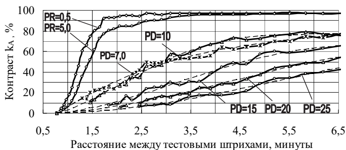
Рис. 6. Контрастность изображений тестовых штрихов миры МЗ–М5 для микропризм «ЗМ» (США)
