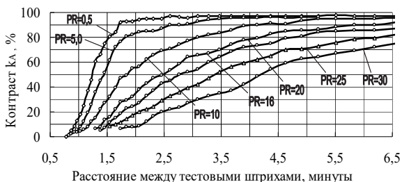
Рис. 3. Контрастность изображений тестовых штрихов миры МЗ–М5 для монопризм «Gulden Ophthalmics» (США)
